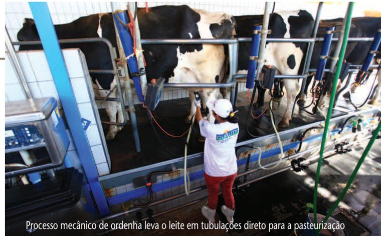
Processo mecânico de ordenha leva o leite em tubulações direto para a pasteurização
