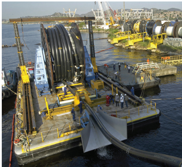
Imagem interna de navio com o produto Wellstream e, à direita, embarque do maior duto flexível já entregue no Brasil – 16” de diâmetro interno – para a P52, da Petrobras
