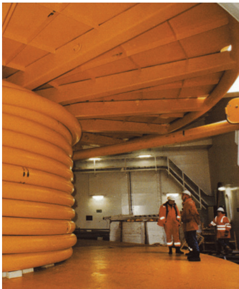
Imagem interna de navio com o produto Wellstream e, à direita, embarque do maior duto flexível já entregue no Brasil – 16” de diâmetro interno – para a P52, da Petrobras
