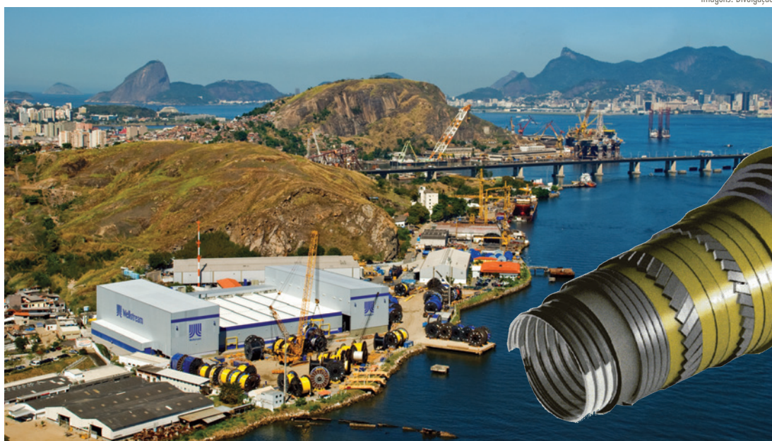
Fábrica Wellstream, em Niterói, RJ. À direita, corte ilustrado do duto flexível feito de aço carbono e polímero, com até 16" de diâmetro interno, que leva petróleo bruto à plataforma marítima
